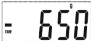
7. Une fois que la mesure négative est affichée sur l'écran LCD, appuyez sur le bouton On/Off/Tare, la mesure sera alors réinitialisée
